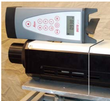
Abbildung 41: Messung des Abstandes zum Messobjekt
