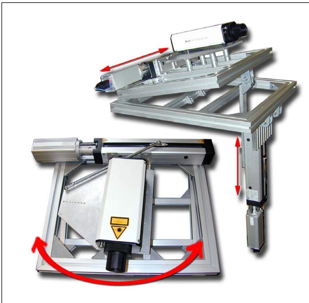
Abbildung 11: Aufbau der Rahmenkonstruktion mit Kugelgewindevorschüben und Messkopf
